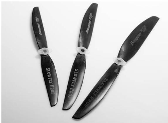
ABB.5: LUFTSCHRAUBEN 16 CM, 18 CM, 20 CM (SCHRIFT HINTEN, GENERATORSEITIG)
