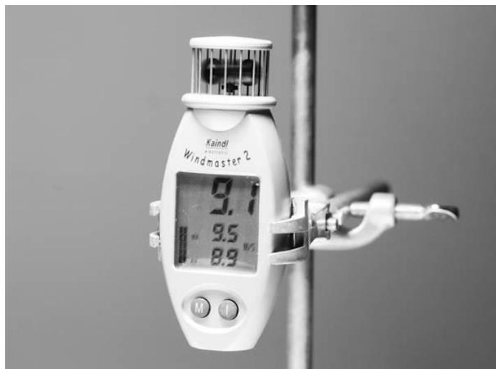
Abb.4: WINDMASTER. DIE ANZEIGE VON OBEN NACH UNTEN: AKTUELLER WERT, MAXIMUM (MX), DURCHSCHNITTSWERT (AV), ALLE IN M/S.
