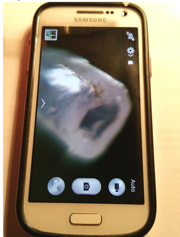
Abbildung 7: Wassertropfen auf der Frontkamera, Bild der Pipette aus ca. 1 cm Entfernung.
